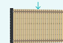
3. Commencez par insérer une lame au milieu du panneau pour maintenir les profils horizontaux, puis insérez toutes les lames.
