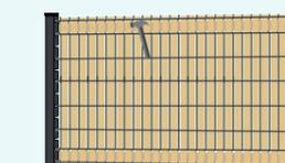
4. Fixez les lames sur les profils horizontaux au dos du panneau à l'aide d'une agrafe ou d'un clou.
