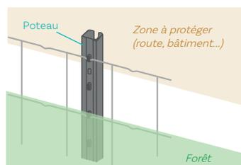
**Conseil de pose :** pour accroître la résistance de la clôture, les poteaux se posent à l'intérieur de la zone à protéger.
